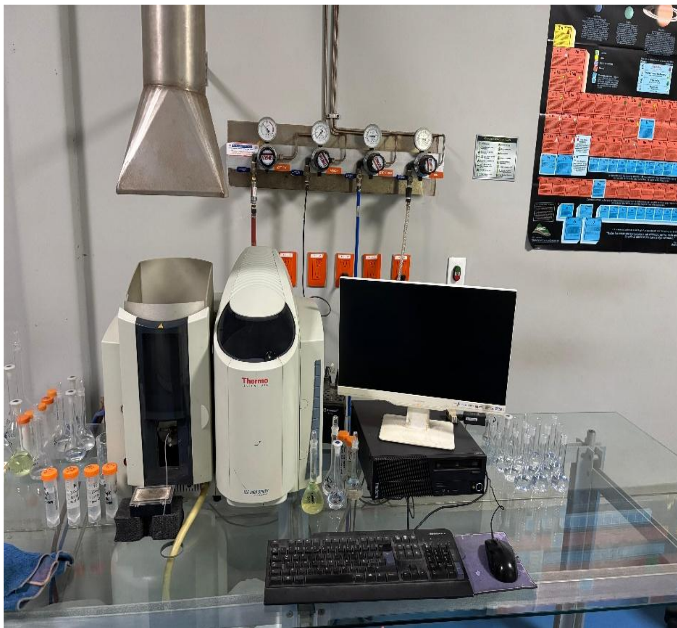
Imagen 4. Absorción Atómica Modelo 3300 de Termo Fisher
